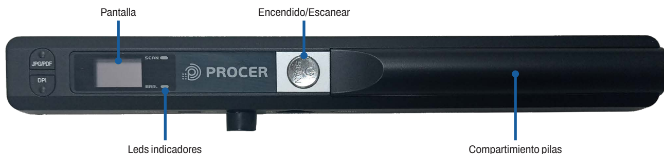
6. Vista superior del escáner portátil adaptado
