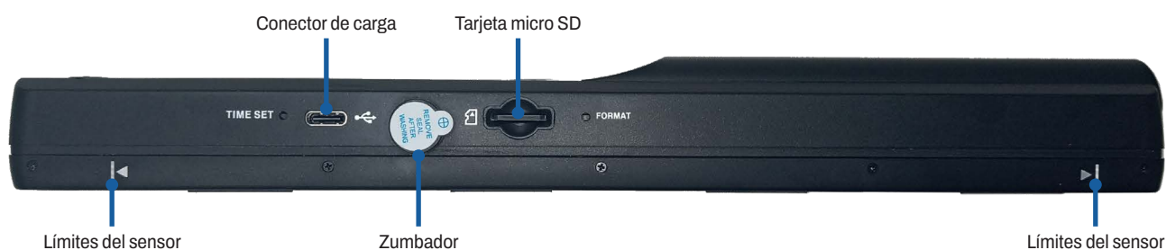
7. Vista lateral superior del escáner portátil adaptado
